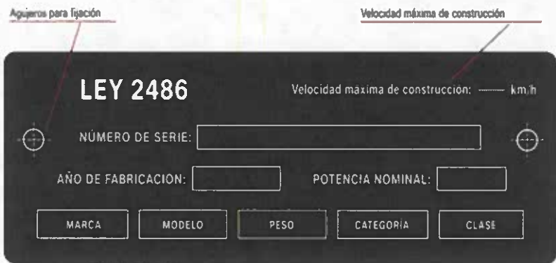
FIGURA 1. DISEÑO TÉCNICO DE LA LÁMINA DE MARCAJE PARA LEY 2486
